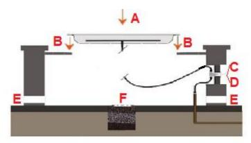
A caixa de comando (C) deve ser instalada em uma das laterais da base do fire pit. Recomendase que fique embutida, para proteção contra choques mecânicos e chuva
