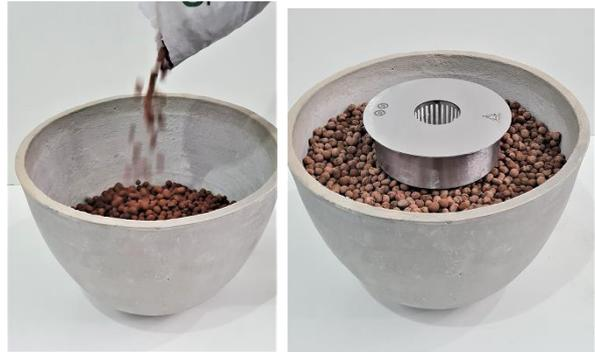
4. Complete o vão que ficar entre o queimador e a base cimentícia com a cinasita, deixando por volta de 2cm livre abaixo do tampo do queimador. A cinasita é um mineral que é isolante térmico.
