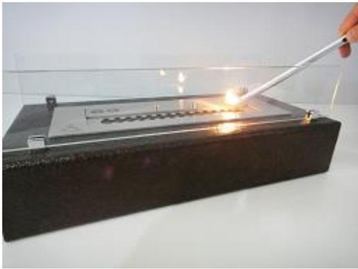
7) Também é possível utilizar a ferramenta de controle da chama para acender o queimador. Mergulhe a ponta da ferramenta, não mais que 5 cm, no álcool/fluido, e com um isqueiro, coloque fogo nesta ponta, formando uma tocha. Insira a ferramenta com fogo no reservatório de combustível.
